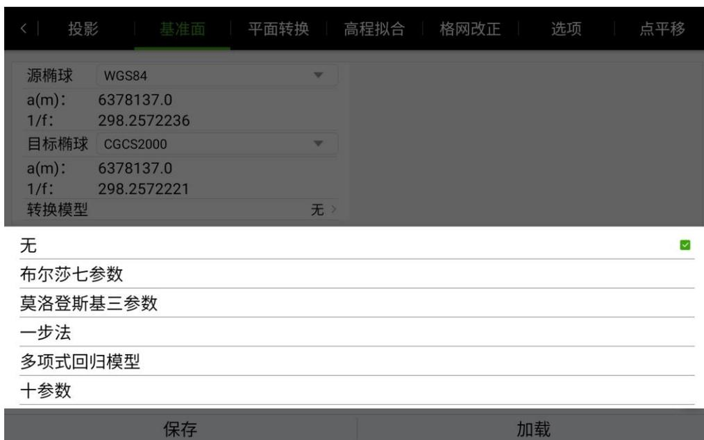
图 3-9 基准面-转换参数
